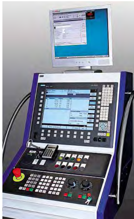
Auf der fahrbaren Bedienkonsole befinden sich zwei übereinander angeordnete Bildschirme. Der untere dient zur Steuerung der Gesamtanlage, der obere ist der Regelung des Schweißprozesses zugeordnet.
