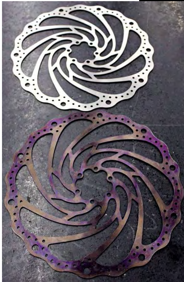
Bei Bremscheiben für Rennräder ist es besonders vorteilhaft, dass der lokal sehr begrenzte Wärmeeintrag beim Laserhärten keinen thermischen Verzug verursacht.
