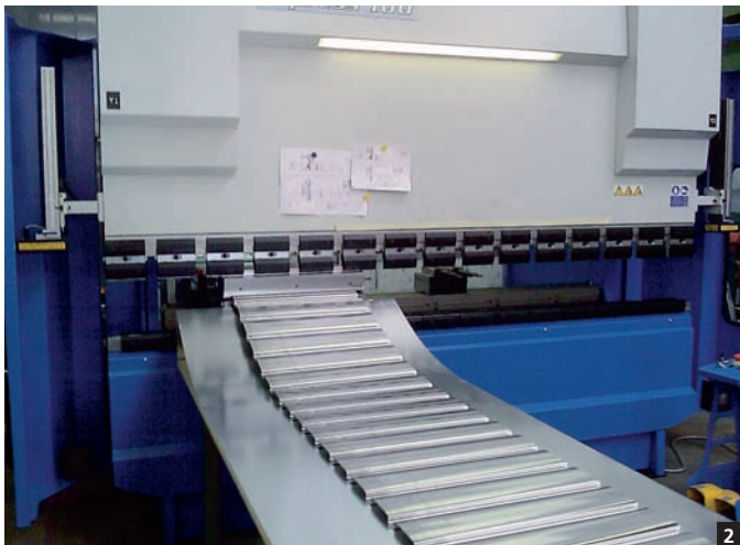
Abkantpresse «X-Press 100» von Gasparini mit profiliertem Furalband.
